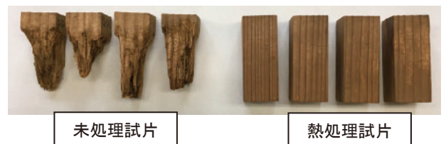
図2 5年間の土中埋設試験を実施したスギ心材試片
