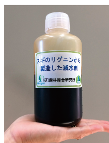
図1 スギのリグニンから製造した減水剤の性能評価
