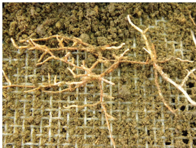
図 1 メッシュシートを通過した細根（メッシュシートの穴径：2 mm）
