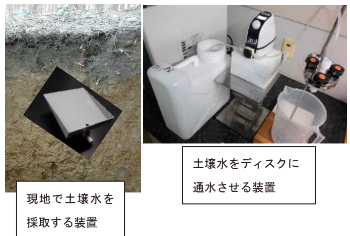
図1 土壌水中の放射性セシウム濃度の測定
