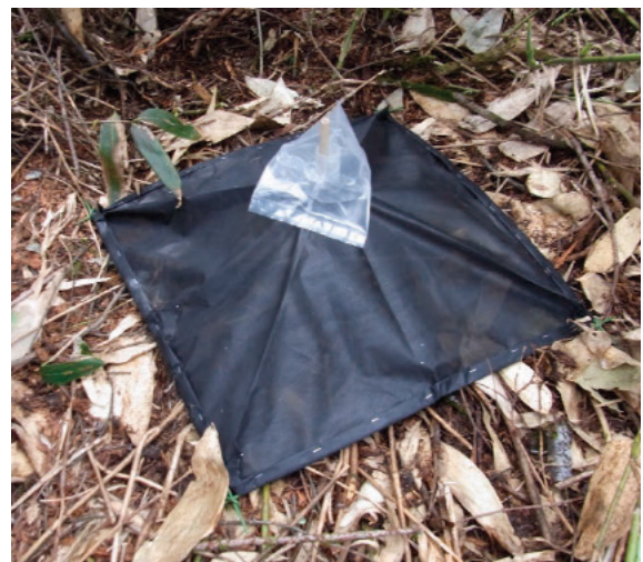
図1 野外に設置した害虫捕獲器
