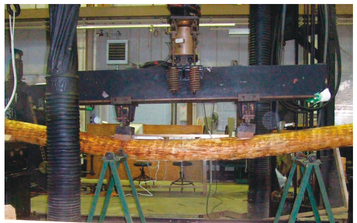
図1 スギ丸太の曲げ破壊試験の様子
