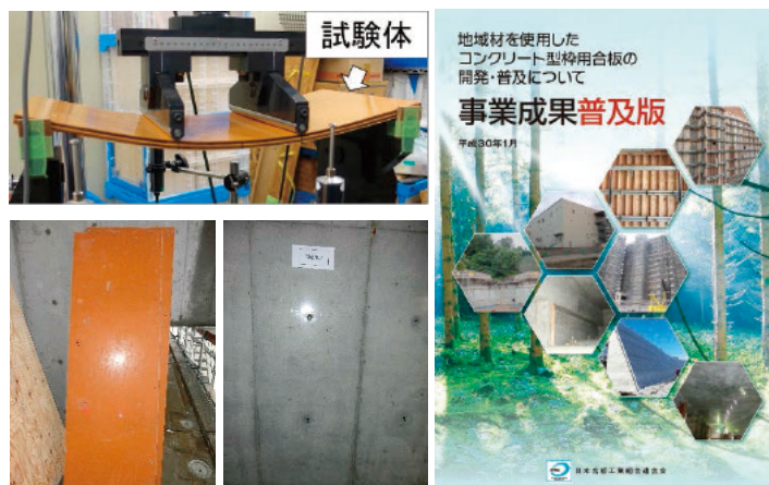
図1 型枠用合板の実験風景と成果マニュアル
