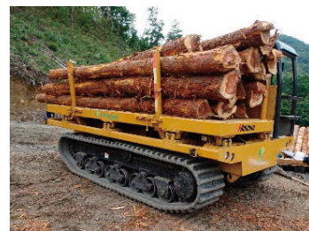
図2 横積式フォワーダ 用材に比べ長尺な一体材を効率的に積載するため、荷台の位置が機体の側方にあるフォワーダ（集材車）を開発しました。
