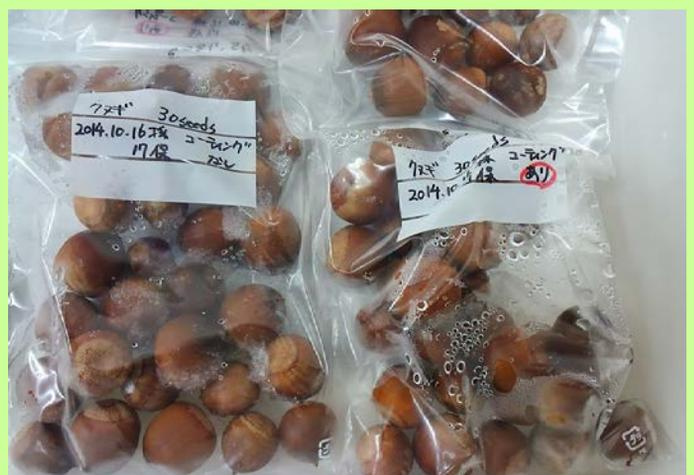
コーティング処理とチルド保存によるナラ類の発根抑制実験の様子。
