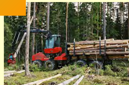
ハーワータ : ハーベスタとフォワーダのハイブ リッドマシン。伐倒から運搬まで行 える林業機械
