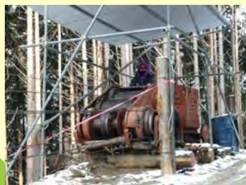
集材機 : 長い架線を張り、 木を吊るして運ぶ
