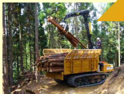
フォワーダ : 丸太を運搬する高性能 林業機械
