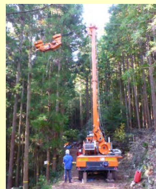
タワーヤーダ : 人工支柱を立て架線 で木を運搬する高性能 林業機械
