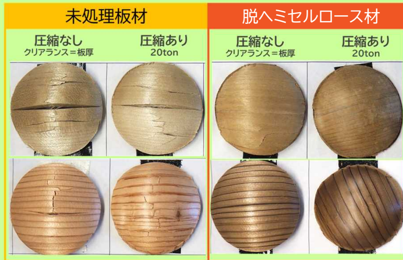
処理材のプレス成形(絞り加工)試験結果 -未処理材との比較-
