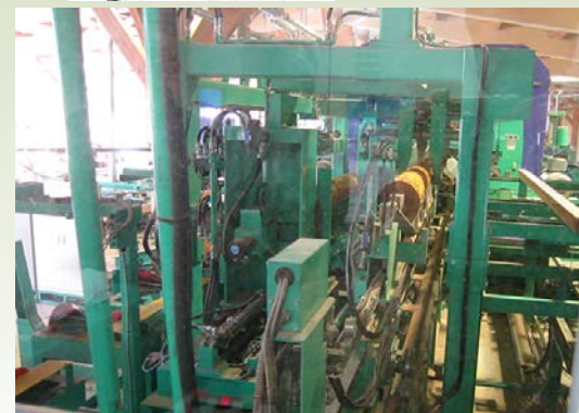
メカトロ化されたツイン帯鋸盤
