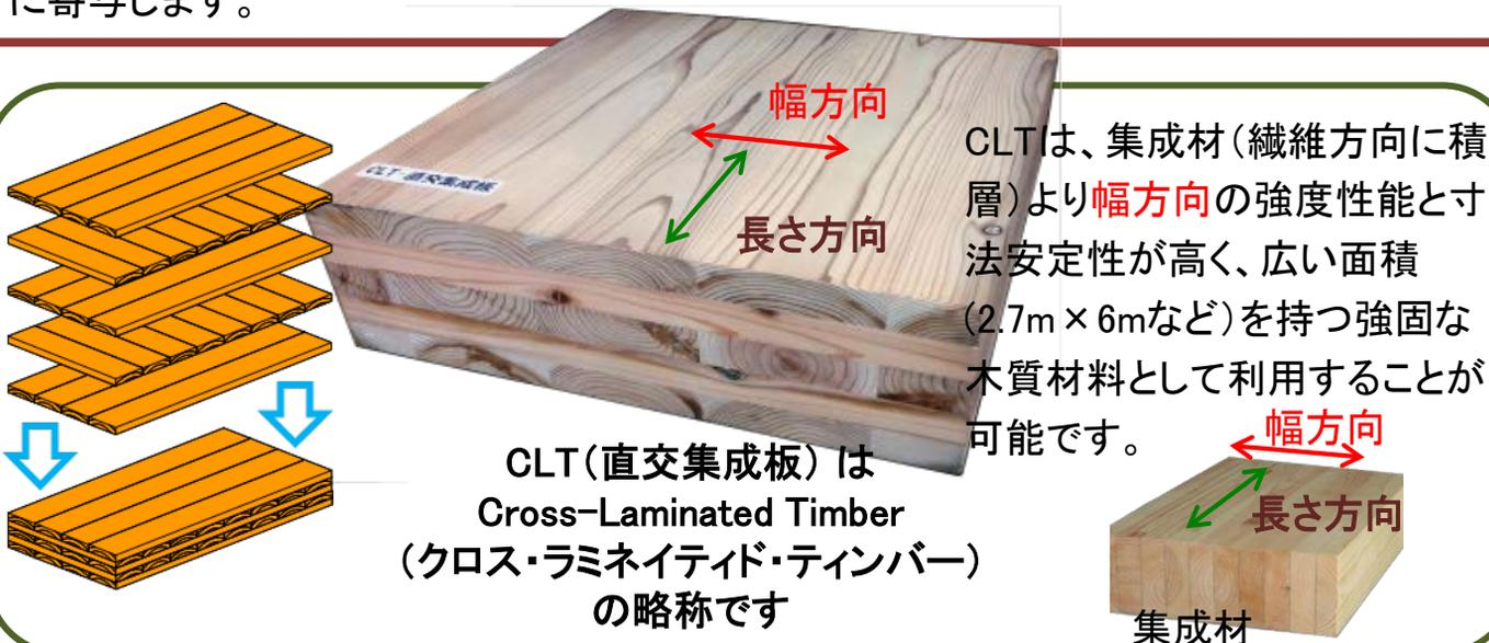
森林総合研究所では、スギなどの国産材を用いたCLTの適正な性能評価方法を検討し、接着性能や各種強度性能を解明しました。
