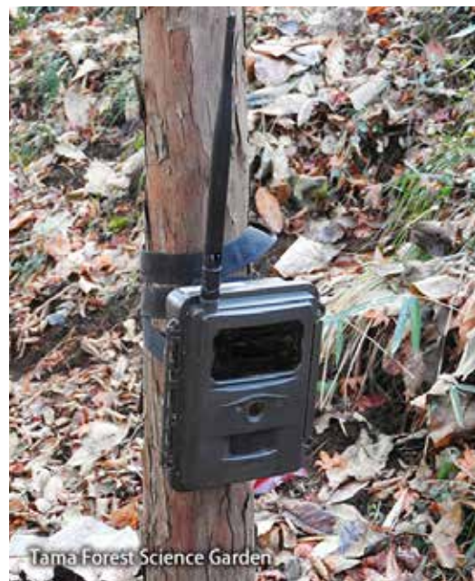
画像が送信される SIM 付カメラトラップ
