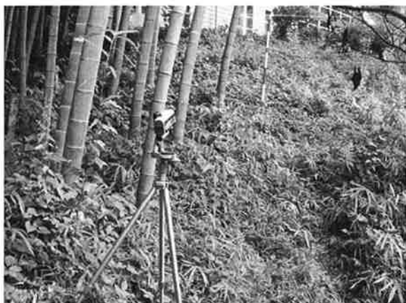
写真-3 レーザー測距コンパスによる区域測量
