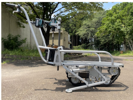
不整地対応型のアウトリガを装備
