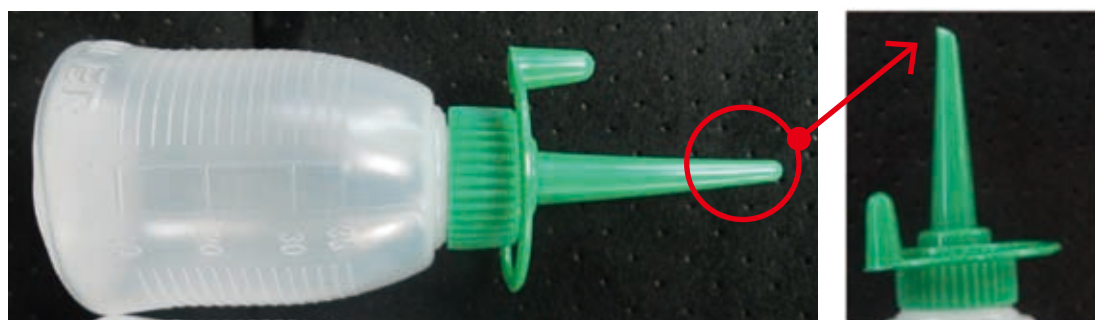
図5. エタノール溶液用の油さし容器（左）と先端部の切断加工（右）
