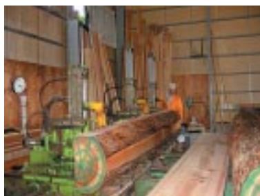
写真－５ 製材風景： 化粧梁 8m×0.45×0.15
