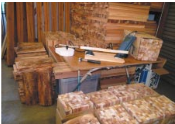
写真－2 曲げヤング率の測定に使用したスギ精英樹の試料
