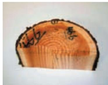
割裂法の調査：木口面で割ると反対側では基準線よりずれている。この長さを測定する。
