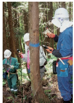
30年生実生検定林で3人一組によるピロディンによる測定
