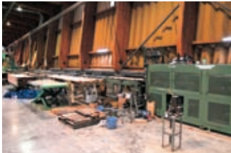
ラミナの材質を全数調査する グレーディングマシン
