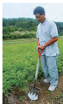
写真-6 穴をあけ軽量化された根切り用の鋤
