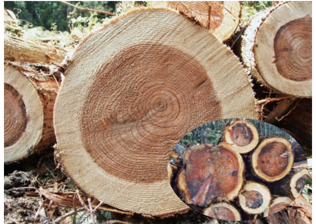
写真－5 大径優良材と円内はスギノアカネトラカミキリ被害材
