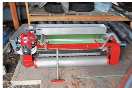
写真-2 まき付け効率化のための播種機
